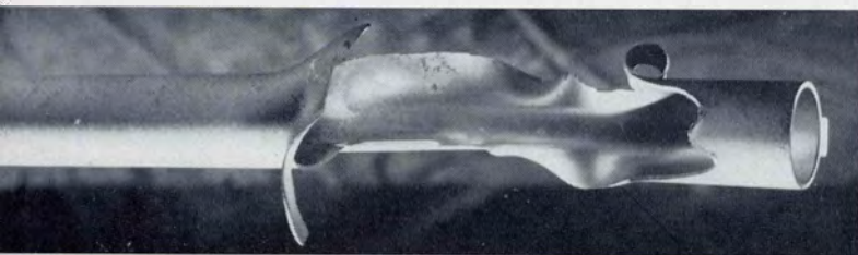
Fig. 3 - Scoppio provocato sparando una cartuccia corazzata (36 gr.) con canna ostruita da una borra e 36 gr. di pallini.
